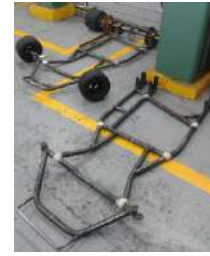
Figura 12. Prototipos de chasis ensamblados con uniones adhesivas.
