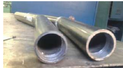
Figura 8. Preparación de extremos de tubería para el ensamble.
