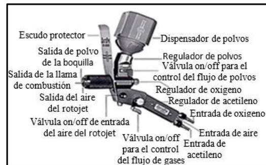
Figura 1. Componentes de la antorcha Eutectic-Castolin Castodyn 8000<sup>TM</sup>.
