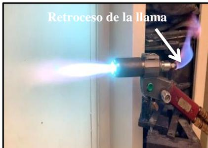
**Figura 3.** Retroceso de llama producido por el Ducto de suministro de polvos.
