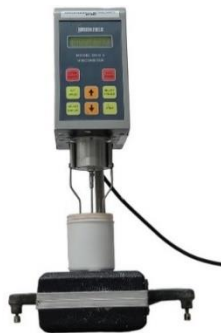
Figura 1. Montaje para evaluación de viscosidad en viscosímetro Brookfield
