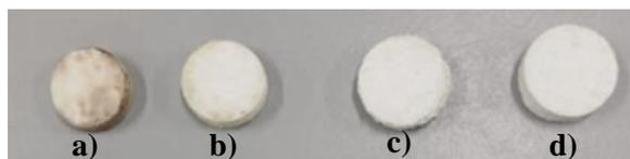
**Figura 2.** *Scaffolds* sinterizados: a) Blanco, b) M5 - 5% en peso de alúmina, c) M15 - 15% en peso de alúmina y d) M25 - 25% en peso de alúmina
