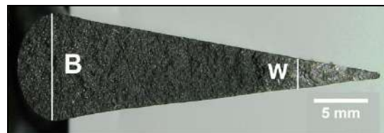
Figura 1. Cuña Tipo W2, la zona ubicada a la derecha de “W” es la zona con chill de esta cuña.
