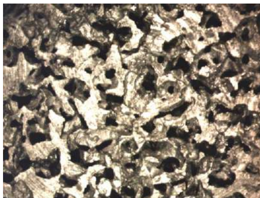
Figura 1. Estructura de poros abiertos e interconectados de la esponja de aluminio
