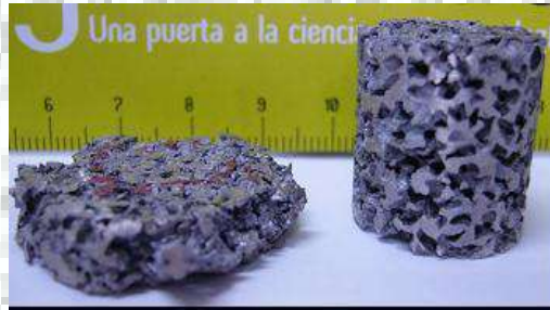
Figura 2. Estructura densificada, luego del colapso de los poros en la esponja sometida a esfuerzos de compresión
