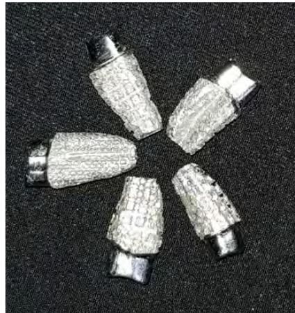
**Figura 2.** Impresión de Piezas sinterizadas
