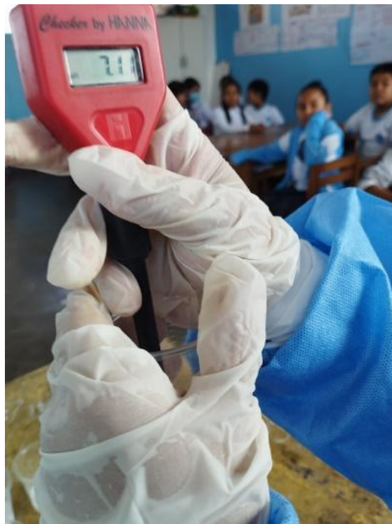
Figura 2. Ejemplo de medición de pH en muestra de saliva
