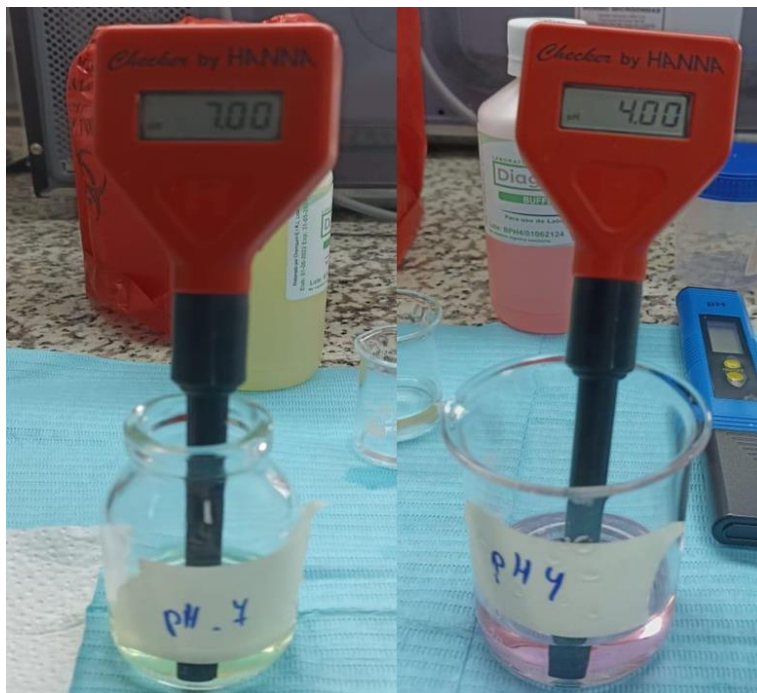
Figura 1. Calibración de medidor de pH digital
