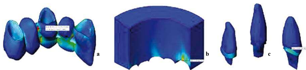
Figura 8. Esfuerzos von Mises en modelo no rígido con situación de carga 4 (sobre pilares y pónicos). Restauración (a), hueso (b) y raíz con ligamento periodontal (c)
