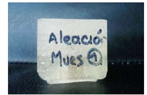
Figura 3. Cubo de resina acrílica de 25 x 25 mm, dentro del cual se ubicó cada espécimen para evitar su deterioro durante el corte
