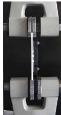
Figura 6. Dispositivo de medición, sujeto a la prensa del Instron
