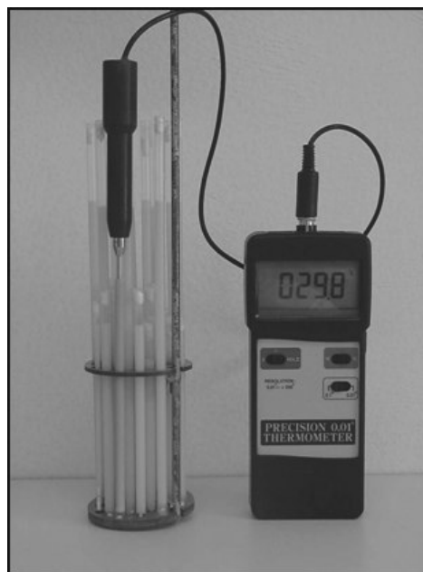
Figura 2. Soporte de polímero de PVC y aluminio, utilizado para la congelación seminal en yamú ( Brycon amazonicus ). Las pajillas son ubicadas de forma vertical. Nótese la sonda de la termocoupla insertada en una de las pajillas para evaluar el descenso de temperatura durante la congelación
