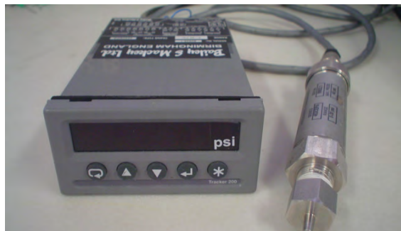
Figura 2. Transductor de presión tipo T443A (Bailey y Mackey, Inglaterra) conectado a un lector digital
