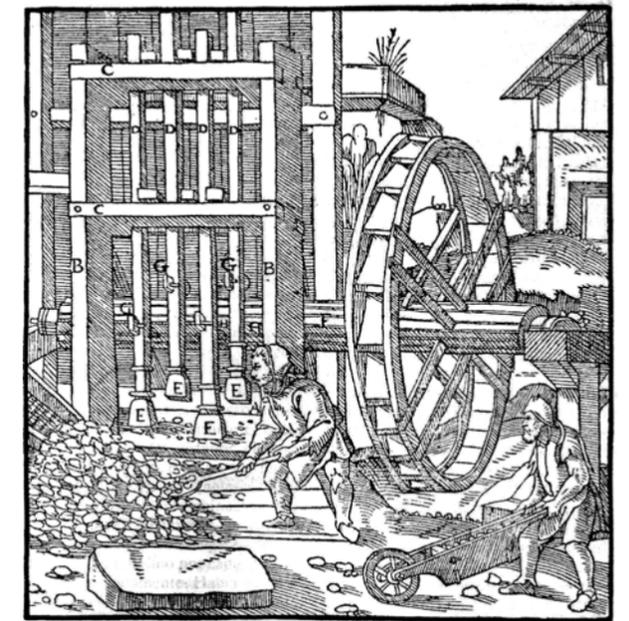
Imagen 3. La leva y la biela en funcionamiento<sup>10</sup>
