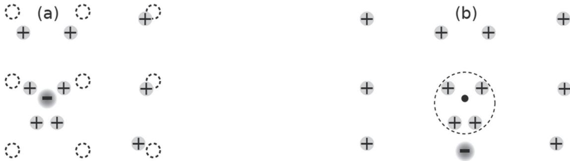
**Figura 1.** En (a) los círculos con líneas a trazos representan las posiciones originales de los iones positivos en el cristal. Debido a la presencia del electrón de valencia, el cristal se polariza y se genera un exceso de carga positiva alrededor del electrón que resulta entonces apantallado. En (b) se muestra cómo el exceso de carga positiva puede causar un efecto de atracción sobre otro electrón de valencia, lo que permite la formación de un par de Cooper.
