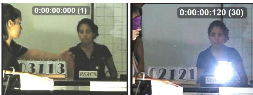
Figura 1. Izquierda: situación para medir el tiempo de reacción visual. Derecha: situación para medir el tiempo de reacción auditivo.
