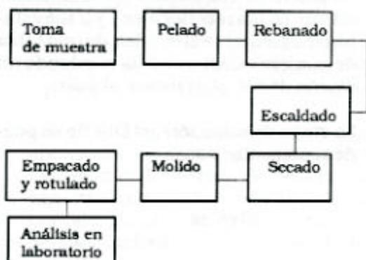
**Figura 1.** Diagrama de flujo para la obtención de harina de guineo y su análisis.
