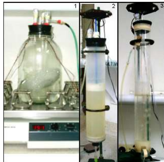
Figura 1. 1. Biorreactor tipo tanque. 2. Tipo columna de burbujeo de una sola etapa (polipropileno). 3. Tipo columna de burbujeo de una sola etapa (vidrio).
